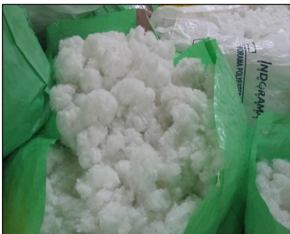
ภาพถ่ายที่ 17 ภาพขณะรวบรวมเส้นใยสังเคราะห์ โพลีเอสเตอร์ ชนิดเส้นใยสั้น
