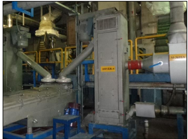
ภาพถ่ายที่ 2 พัดลมดูดอากาศ ภายในเครื่องอบแห้ง
